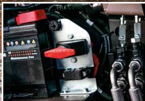
Batteri-afbryderkontakt til sikker vedligeholdelse.
