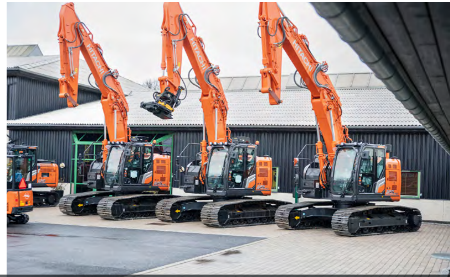
Hitachi ZX225USLC-7 med multibom har en arbejdsvægt på 26,4 ton.
