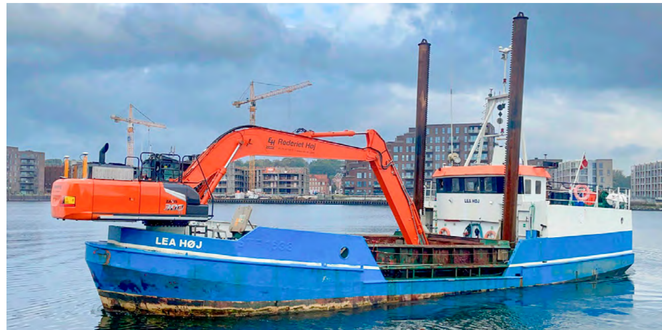
Tårnet fra gravemaskinens undervogn er skåret af og svejset på skibet som en piedestal.
