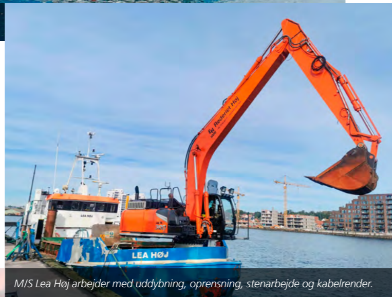
Tårnet fra gravemaskinens undervogn er skåret af og svejset på skibet som en piedestal.
