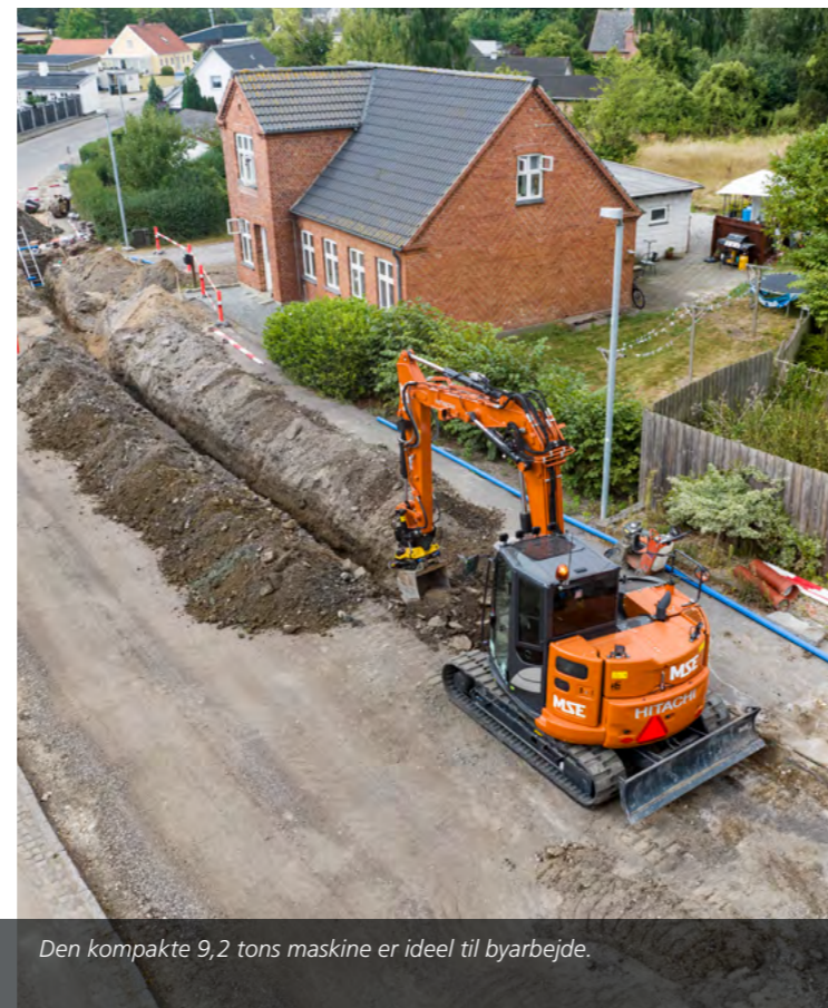
Todelingen af citybommen øger gravemaskinens fleksibilitet, da skovlen kan komme tættere på maskinens kabine.
