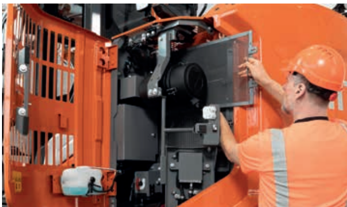
Forstørret kølerhjul (ZX135US-7) giver nem adgang til rengøring og vedligeholdelse.
