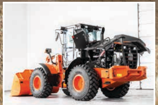
Nem adgang til vedligeholdelse fra terrænniveau.
