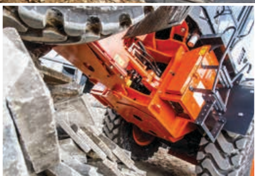
Bundkarbeskyttelsen (ekstraudstyr) yder ekstra beskyttelse.
