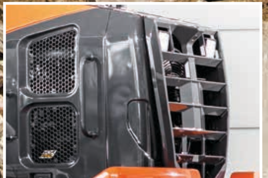
Kølere med stor ribbeafstand (ekstraudstyr) giver bedre holdbarhed.
