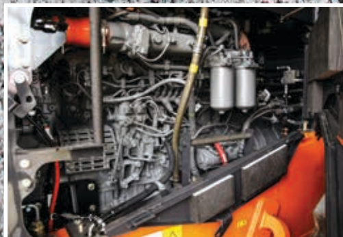
Tier IV-motor nedsætter brændstofforbruget.
