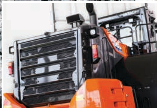
Nyt baggitter beskytter kølerummet.
