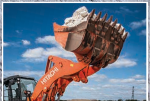
Flowkontrollsystemet sikrer jævn bevægelse af løftearmen.
