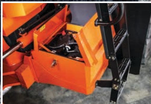
Batteriet er let at vedligeholde.
