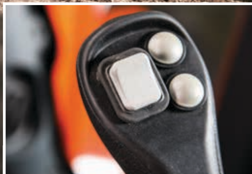
Quick Power-kontakten øger ydelsen, når der er brug for det.
