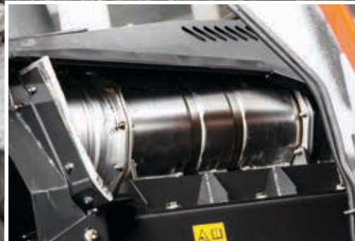
SCR-systemet reducerer emissionerne og støjniveauet.
