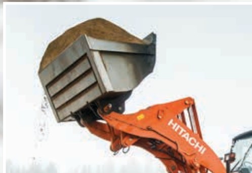
Flowkontrollsystemet sikrer jævn bevægelse af løftearmen.
