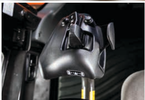
Joystick-styresystemet (ekstraudstyr) giver exceptionelt effektiv styring.
