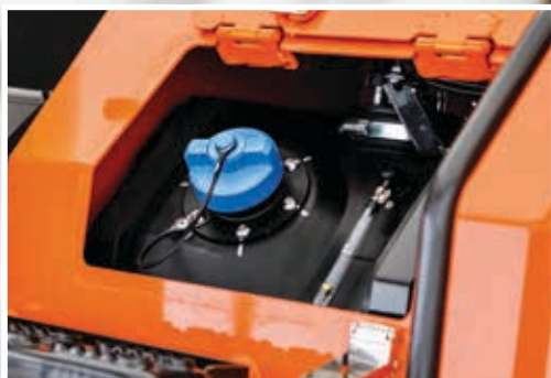
Urea sprøjtes ind i udstødningsgassen for at reducere emissionerne.
