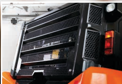
Nyt baggitter beskytter kølerummet.
