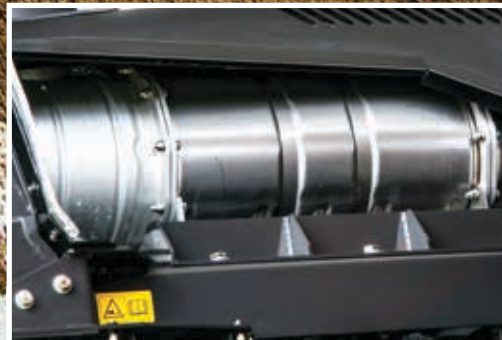
SCR-systemet reducerer emissionerne og støjniveauet.
