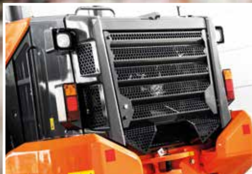
Nyt baggitter beskytter kølerummet.
