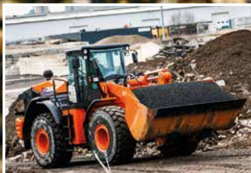
Skovlaffjederen sikrer jævn kørsel.
