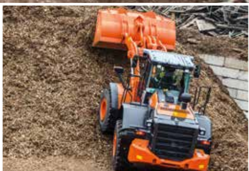
Bundkarbeskyttelsen (ekstraudstyr) yder ekstra beskyttelse.
