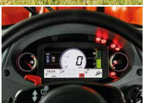
LCD-monitoren viser maskinens status og indstillinger.
