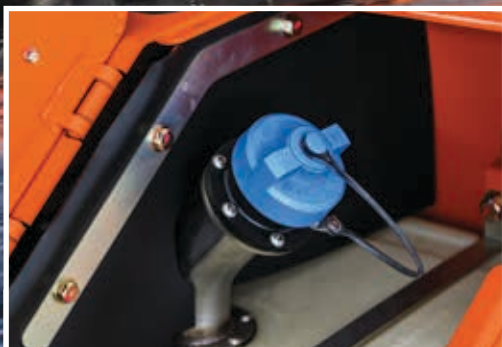
Urea sprøjtes ind i udstødningsgassen for at reducere emissionerne.
