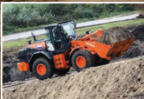
Automatisk effektfunktion forbedrer ydeevnen op ad bakke.
