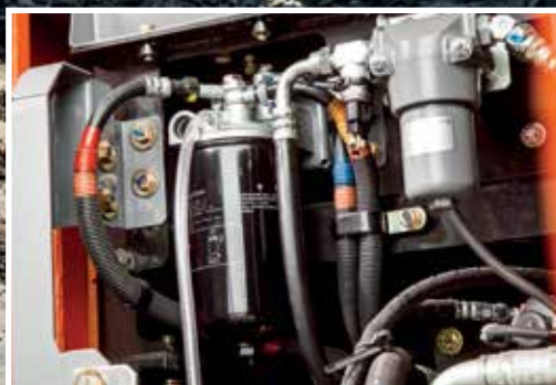
Brændstof-hovedfilteret er lettere at udskifte.
