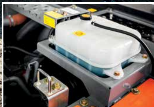
Ekspansionsbeholderen forhindrer overophedning af motordelene.
