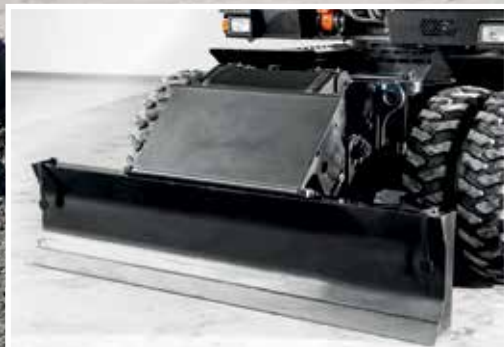
Stor bladcylinderafskærmning giver ekstra beskyttelse.
