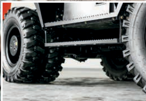
Stor frihøjde reducerer risiko for skader fra ujævnheder i terræn.
