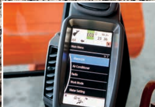
LCD-skærmen viser maskinens status og indstillinger.
