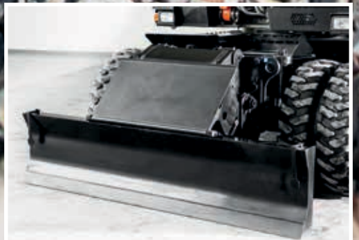
Stor bladcylinderskærmning giver ekstra beskyttelse.
