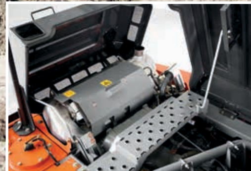
SCR-systemet reducerer emissioner og støj.
