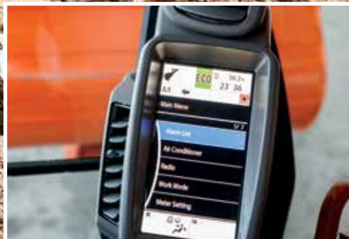
LCD-skærmen viser maskinens status og indstillinger.
