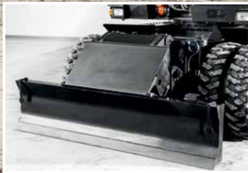
Stor bladcylinderskærmning giver ekstra beskyttelse.
