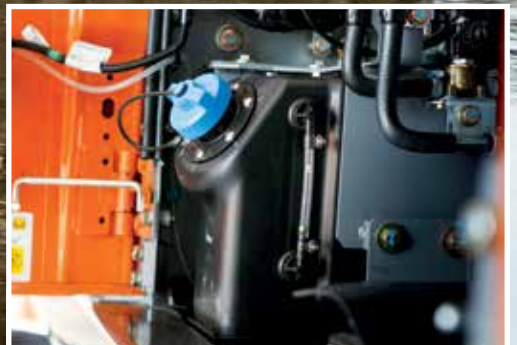
Urea (AdBlue®) indsprøjtes i udstødningsslangen til reduktion af emissioner.
