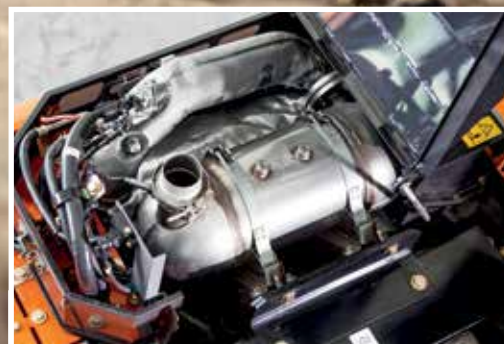
SCR-systemet reducerer emissioner og støj.
