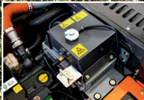
Ekspansionsbeholderen forhindrer overophedning af motordelene.
