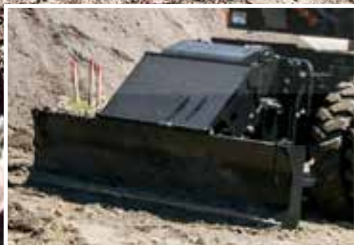
Stor bladcylinderafskærmning giver ekstra beskyttelse.
