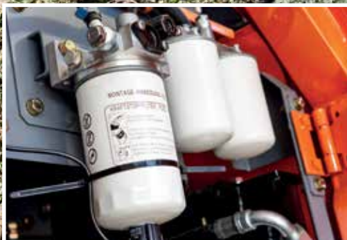
Brændstof-hovedfilteret er lettere at udskifte.
