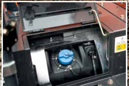
Urea indsprøjtet i udstødningssagen for at reducere emissioner.
