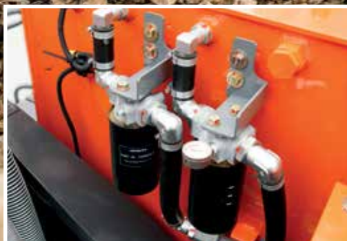
Brændstof-hovedfilteret er let tilgængelig for udskiftning.
