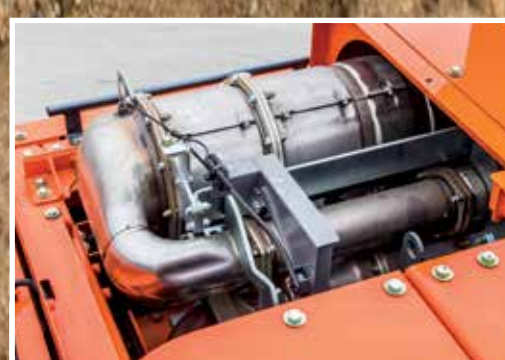
SCR-systemet reducerer emissioner og støj.
