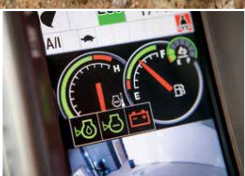
LCD-skærmen viser maskinens driftsstatus og indstillinger.
