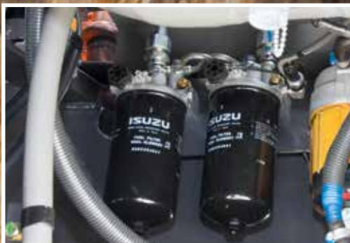
Brændstof-hovedfilteret er let tilgængelig for udskiftning.
