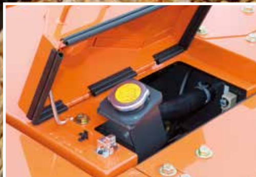
Ekspansionsbeholderen forhindrer overophedning af motordelene.
