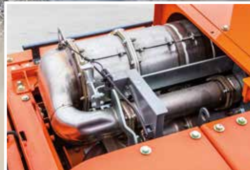
SCR-systemet reducerer emissioner og støj.
