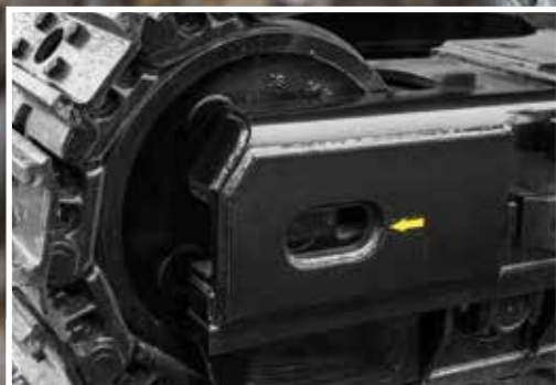
Forstærkede skærme for forhjul og finalelev.
