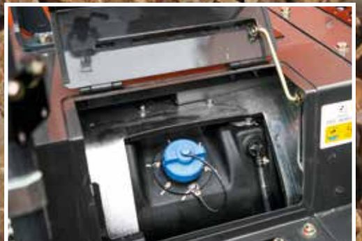
Urea indsprøjtes i udstødningssagen for at reducere emissioner.
