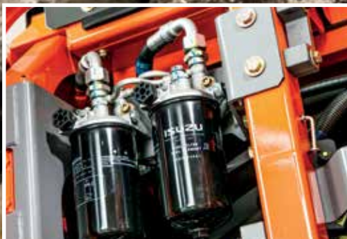
Brændstof-hovedfilteret er let tilgængelig for udskiftning.
