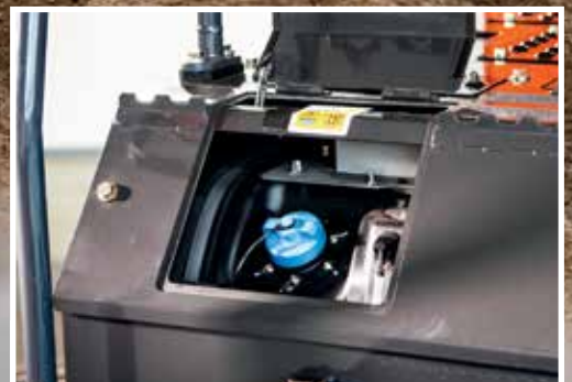
Urea indsprøjtes i udstødningsgassen for at reducere emissioner.
