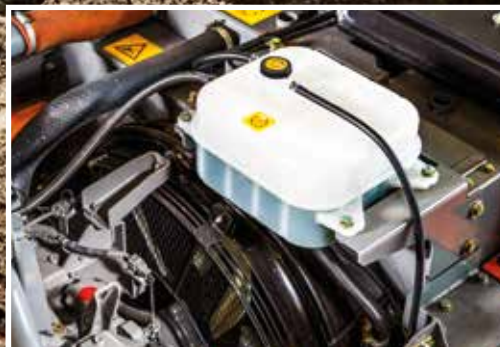
Ekspansionsbeholderen forhindrer overophedning af motordelene.
