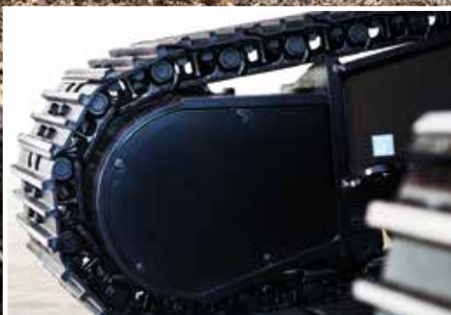
En tykkere afskærmning af køremotoren giver større beskyttelse mod skader.
