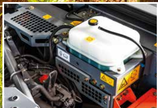
Ekspansionsbeholderen forhindrer overophedning af motordelene.
