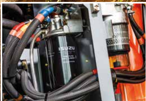
Brændstof-hovedfilteret er lettere at udskifte.
