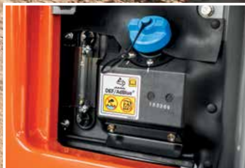
Urea (AdBlue®) indsprøjtes i udstødningsgassen til reduktion af emissioner.
