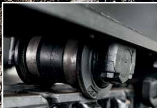
Nydesignet underrulle forhindrer mudder i at trænge ind og forårsage skader.
