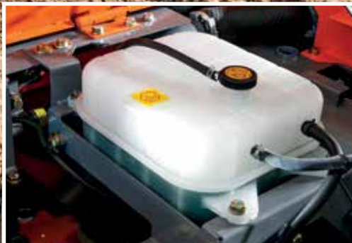
Ekspansionsbeholderen forhindrer overophedning af motordelene.
