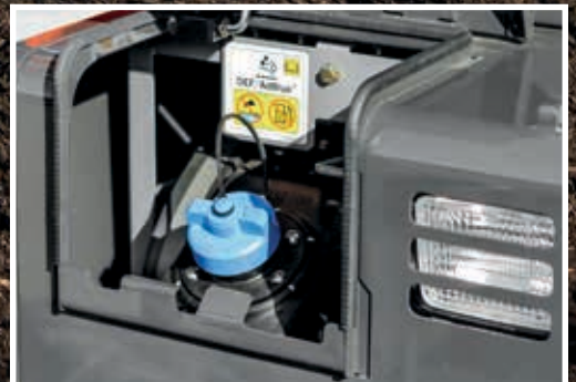
Urea (AdBlue®) indsprøjtes i udstødningssagen til reduktion af emissioner.
