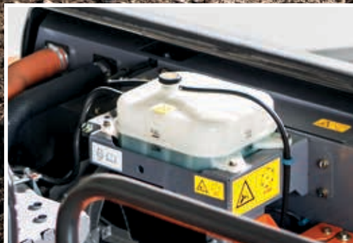
Ekspansionsbeholderen forhindrer overophedning af motordelene.
