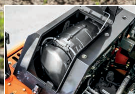
SCR-systemet reducerer emissioner og støj.
