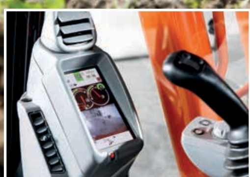
LCD-skærmen viser maskinens status og indstillinger.
