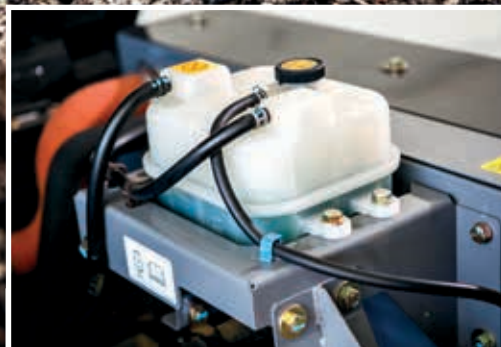
Ekspansionsbeholderen forhindrer overophedning af motordelene.
