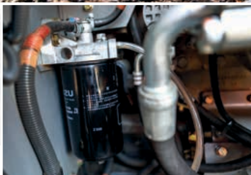
Brændstof-hovedfilteret er lettere at udskifte.
