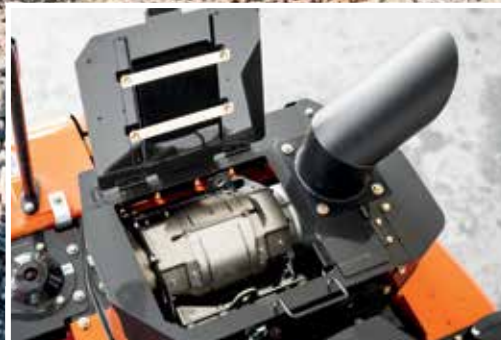
SCR-systemet reducerer emissioner og støj.
