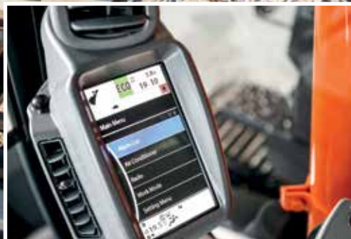
LCD-skærmen viser maskinens status og indstillinger.
