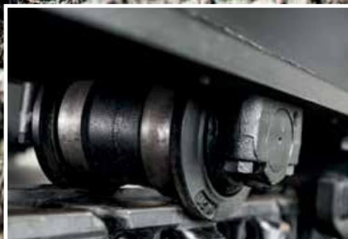
Forstærket bøsningmateriale øger slidstyrken.
