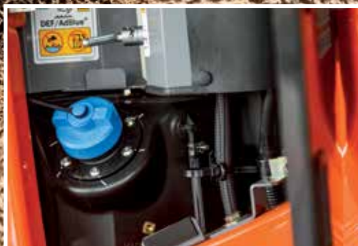
Urea (AdBlue®) indsprøjtes i udstødningsskeden til reduktion af emissioner.
