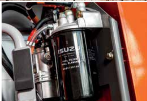
Brændstof-hovedfilteret er lettere at udskifte.
