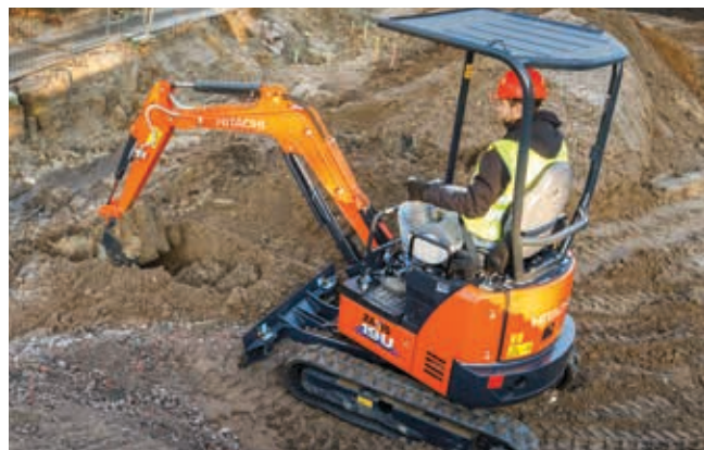
Styrtbøjlen med tre stolper øger udsynet.
