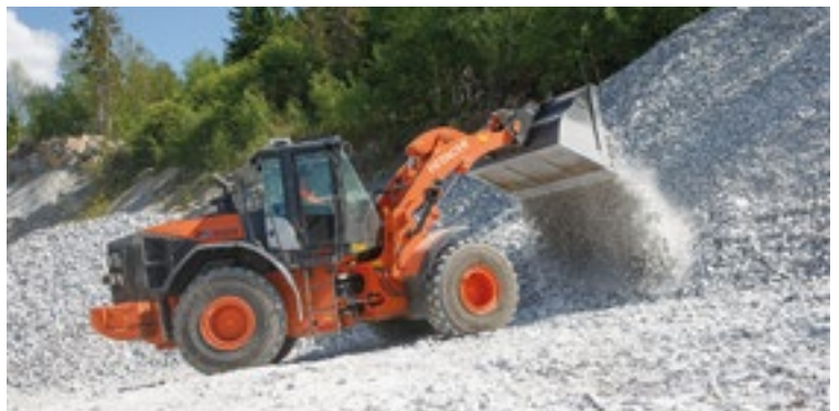
Læssernes Power Boost funktion gi'r ekstra motoreffekt – f.eks. når læsseren er på vej op ad en bakke.
