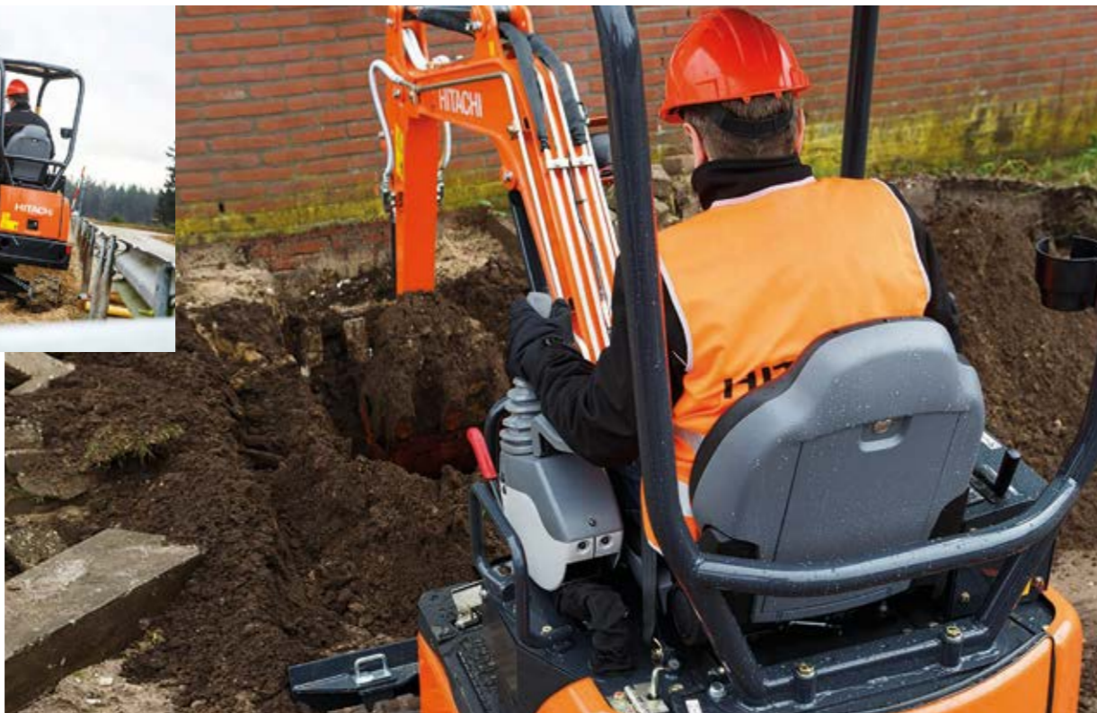
Udskydelig undervogn, kan variere ZX19U-5A's bredde fra 980 mm til 1280 mm.
