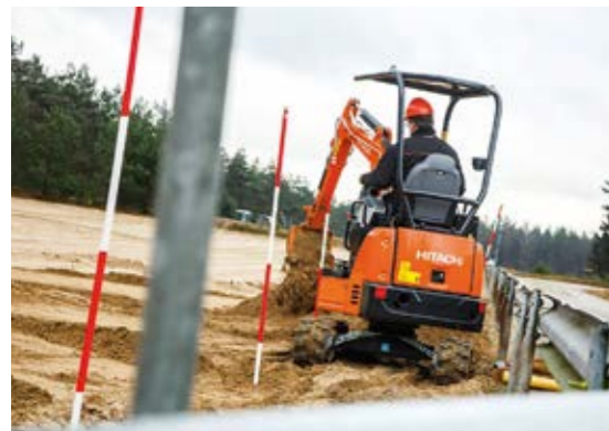
Udskydelig undervogn, kan variere ZX19U-5A's bredde fra 980 mm til 1280 mm.
