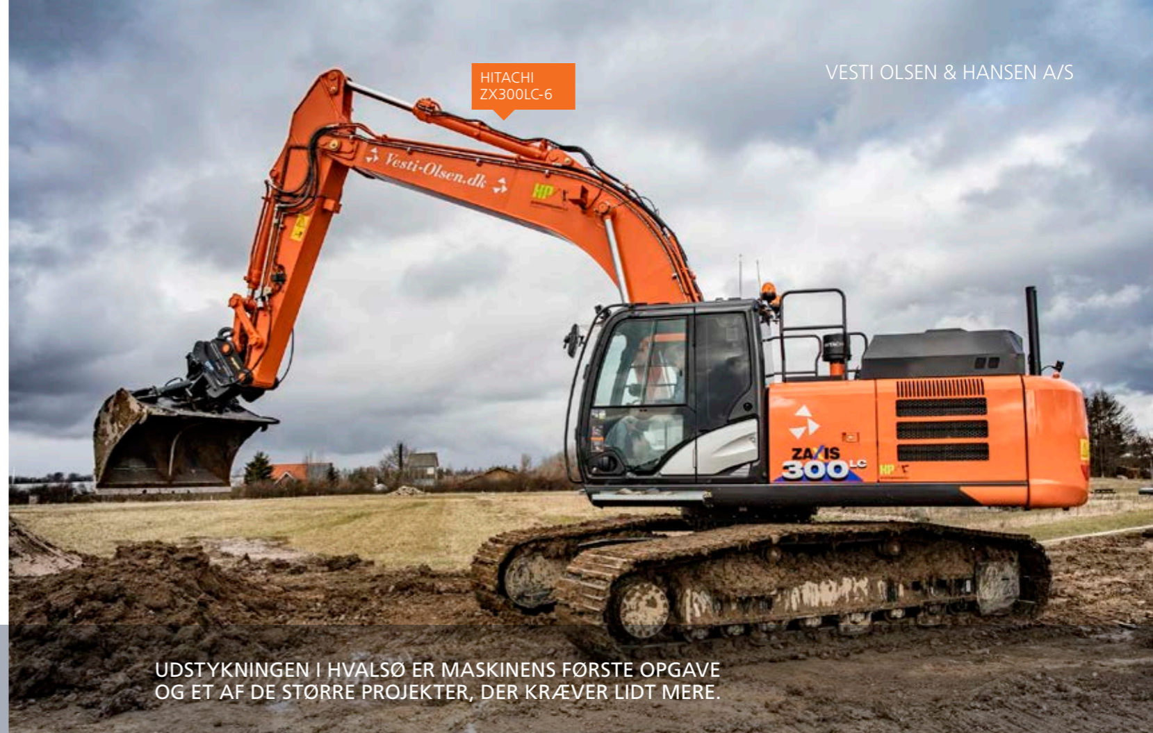
Frontudstyret bevæger sig hurtigere, fordi hver aktuator har sin egen pumpe.
